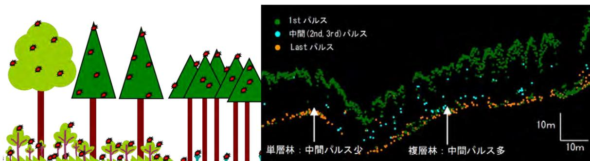
図 2-27 森林域における航空レーザ計測のイメージ（左）および点群データイメージ（右）
