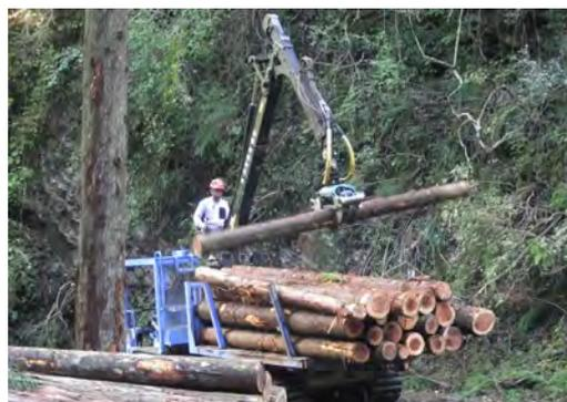
図 5-10 東栄町で導入されている林業機械 [スイングヤーダ (左)、フォワーダ (右)]
